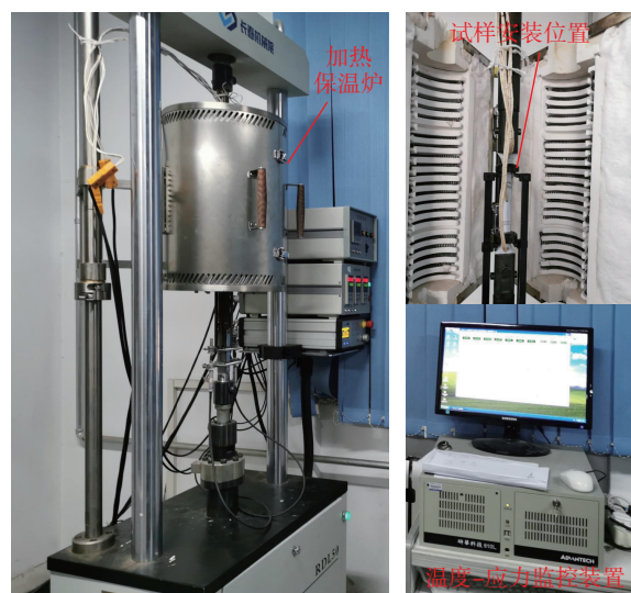
图1 应力松弛试验装置
